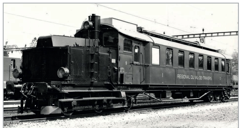
Abb. 5: Dieselelektrischer Triebwagen, gebaut in Deutschland um 1915. Eingesetzt im Val-de-Travers ab 1924. Das Gefährt war noch nach der Elektrifizierung 1944 bis 1965 in Betrieb
