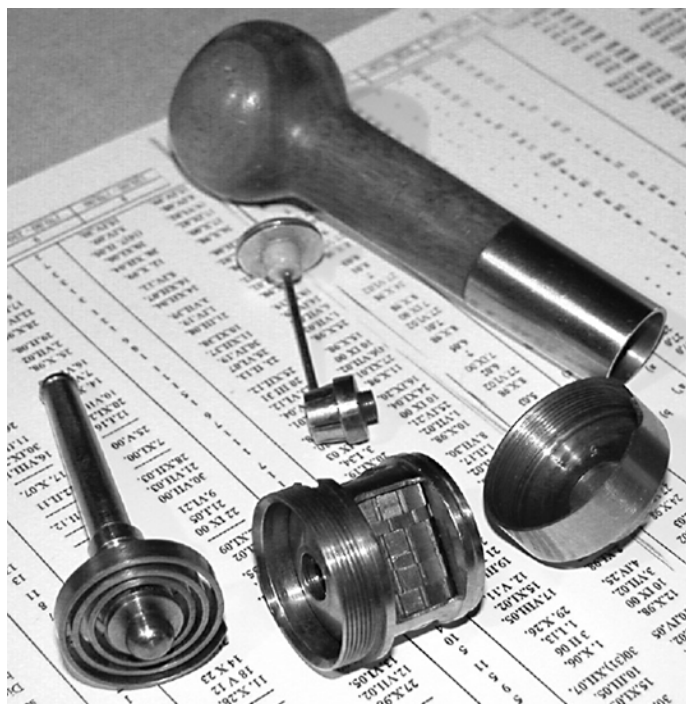
Abb 5.2: Originalstempel nach der Konstruktion von 1903 mit gekapselter Schneckenfeder; Foto: Michael Rutherford
